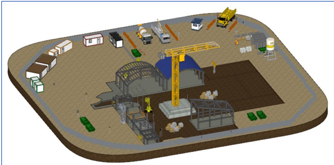
Fig. 5 Vista 3D planificación posiciones de casetas y recorridos de accesos maquinaria.
