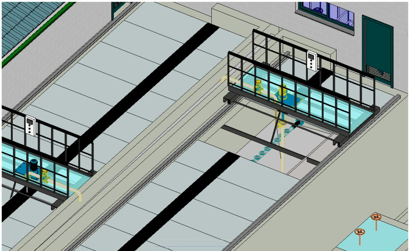
móvil, que va a ir absorbiendo las arenas del fondo, y una pala superficial para ir arrastrando las grasas flotantes, vertiéndolas en una cesta de recogida.
