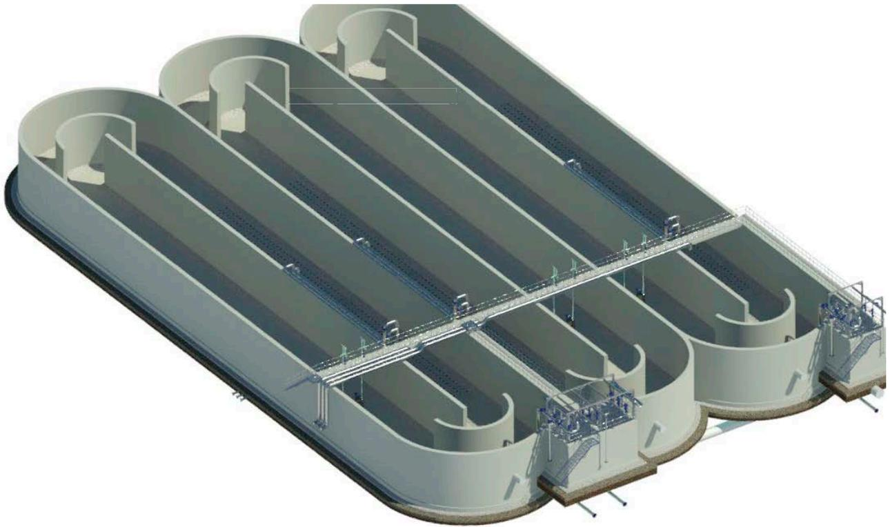
Estos microorganismos flocculan entre si formando unidades más pesadas, que decantan en el siguiente recinto llamado **decantador secundario**. Este recinto contiene agua más calmada que favorece la decantación, junto a un equipo mecánico rotatorio con unas rasquetas en el fondo que amontona los fangos o lodos en la tubería de aspiración.
