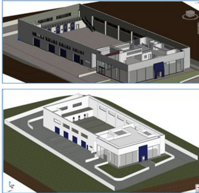
Figura 6. Particiones interiores. Imagen Superior en Revit, e imagen inferior en Edificius. María Nuria Ortega López.
